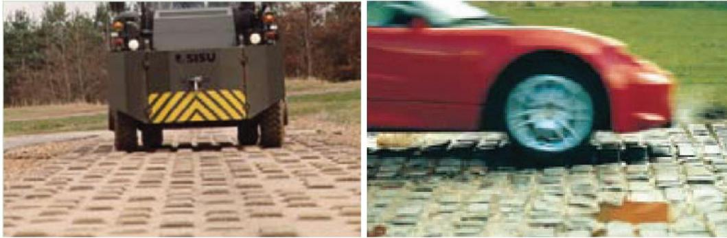
Figure 29 : Surfaces d'essai de piste accidentée (à gauche) et de revêtement belge (à droite).
