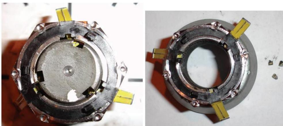
Figure 36 : Exemple de déformation des broches Visilok lors du test Junkers. Goupilles cisailées affichées à droite.
