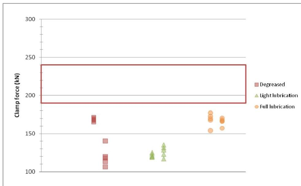
Figure 12 : Comparaison des exigences de la norme BS AU 50 avec la force de serrage moyenne générée avec les goujons et écrous utilisés en utilisant la méthode de serrage au couple et un couple appliqué de 600 Nm.
